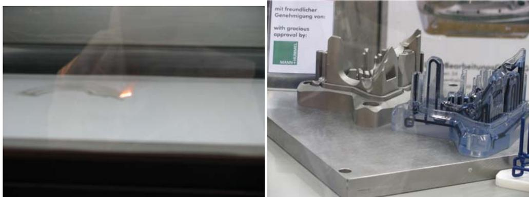
図18 LBC のレーザー焼結による 3 次元冷却配管
