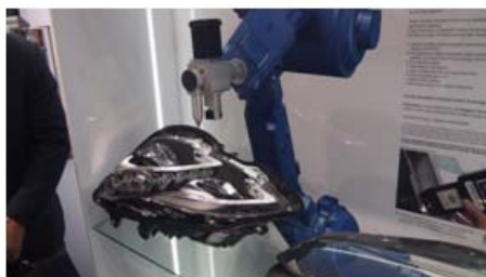
図10. Plasmatreat社のブースの小型の大気圧プラズマ処理装置とヘッドランプのシール部分に処理を行っているイメージの展示
