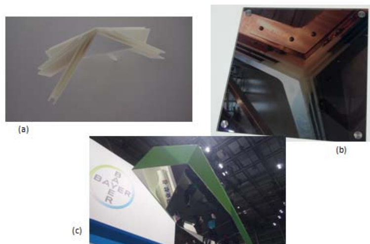
図14. Bayer社のブースに展示されていた紫外線硬化型ウレタンによる造形品(a)と構造部材を接合した状態の写真(b)、および同部品を用いたブースの造作物(c)
