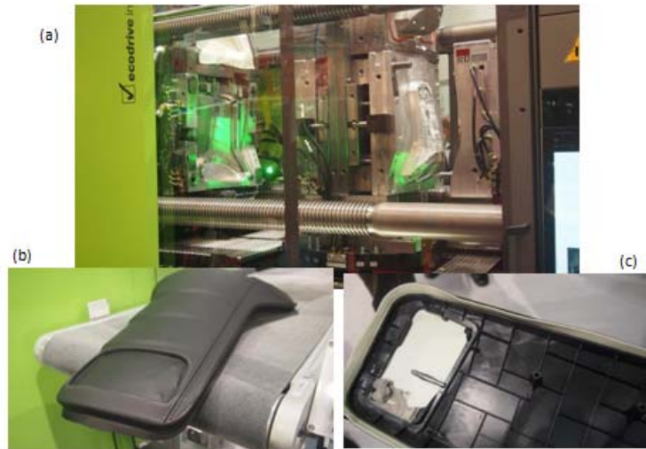
図5. ENGELのソフトタッチ成形プロセスの金型(a)と成形品の表面(b)、裏面(c)
