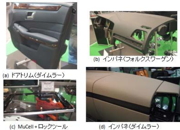
図3. TREXELのブースに展示されていた自動車内装部品等 (a) ドアトリム(ダイムラー) (b) インパネ(フォルクスワーゲン) (c) MuCellとRocToolの誘導加熱を併用したピアノブラック成形品 (d) ENGELのDolphine法(対抗二色、コアバック)でエラストマーを高発泡
