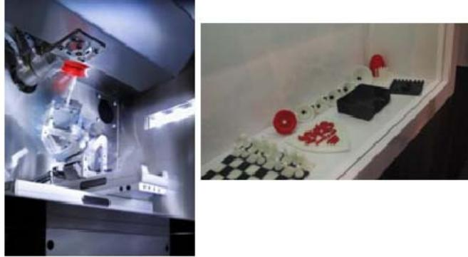
写真1. ARBURGの3Dプリンター-freeformerの造形ヘッド部分(左)と成形品サンプル(右)
