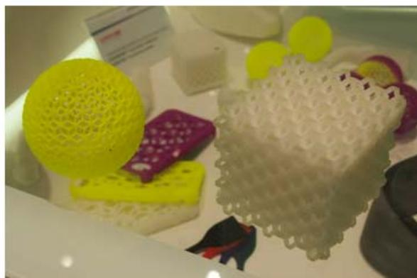
写真16. Lehmann & Voss & Coブースに展示されていたBayerのウレタンエラストマーを原料とした粉末から造形したサンプル
