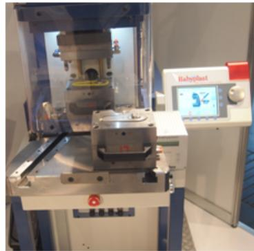
図4 babyplastブースにおける鑿型インサート成形機
