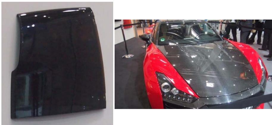
写真10. KraussMaffeiブースで成形実演していたRTMサンプル(左)と、RTM成形品を使用した自動車見本(右)
