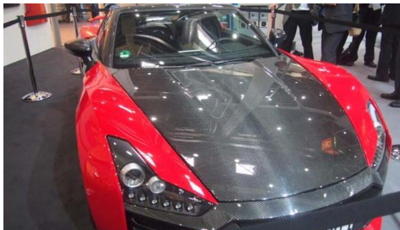
RTMによる成形品を活用した 自動車の試作品 (KraussMaffei)
