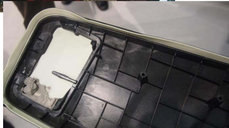
ENGELのソフトタッチ成形プロセスの金型(a)と成形品の表面(b)、裏面(c)
