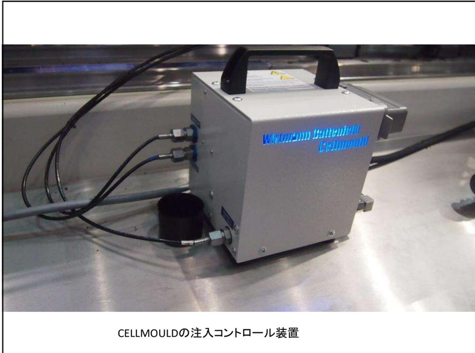
CELLMOULDの注入コントロール装置
