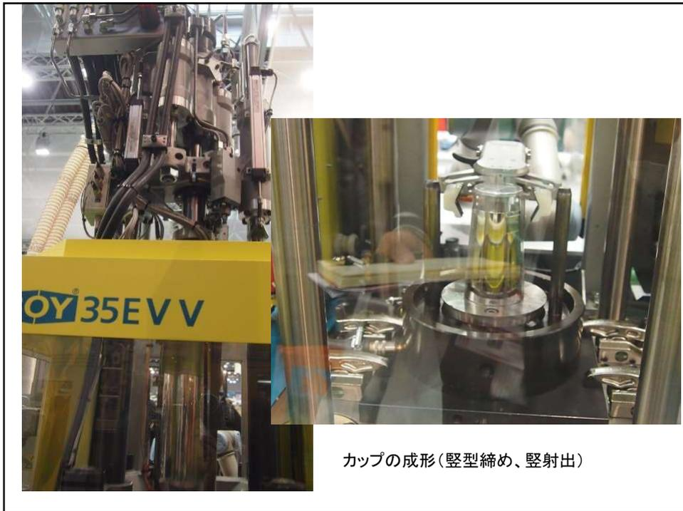
カップの成形(縦型締め、縦射出)
