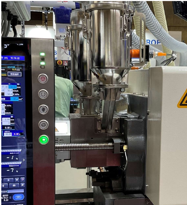
二材混合できる成形機 ホッパー2基, 混錬用スクリュー
