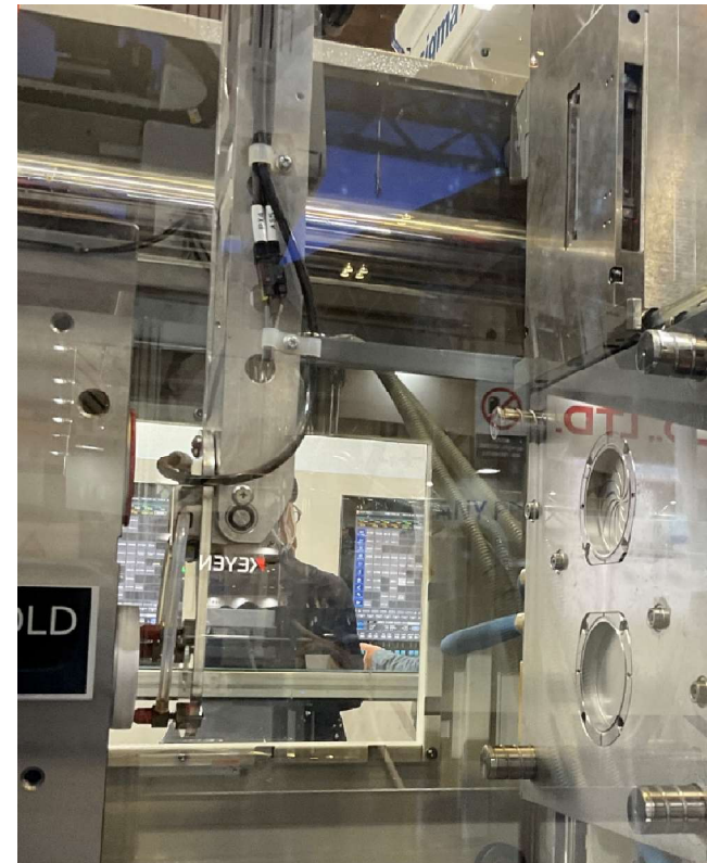
小型サブ射出ユニットを用いた二色成形 キャノンモールドのユニット エアシリンダーでキャビティを回転
